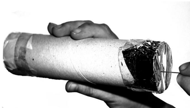
Fig. 13a și 13b: Model pentru camera obscură.
